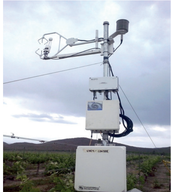
Figura 1. Sensores de un sistema Eddy sobre una plantación de vid (cv. Shiraz) para medir el intercambio neto de bióxido de carbono (NEE) entre el dosel del viñedo y la atmosfera.
