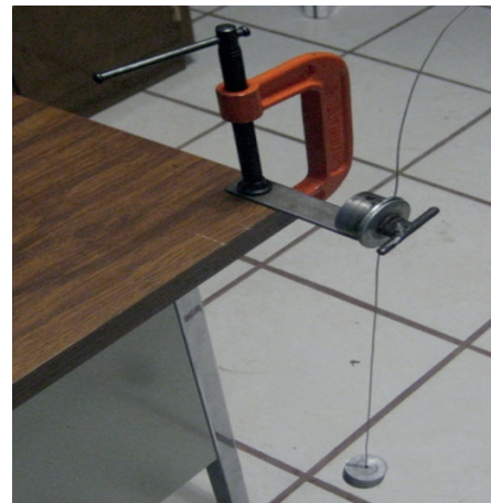
Figura 4. Péndulo torsional para determinar el momento de inercia del cilindro patrón.
