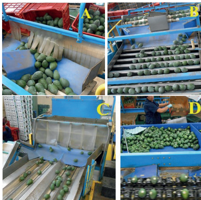
Figura 1. Etapas del proceso de selección y empaçado de aguacate 'Hass' para exportación: A) vaciado de frutos; B) rodillos y cepillos; C) selección manual, singulador y etiquetado; y D) caída a la tolva y tolva.
