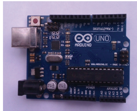
Figura 1. Aspecto físico del Arduino UNO. Figure 1. Physical appearance of the Arduino UNO.
