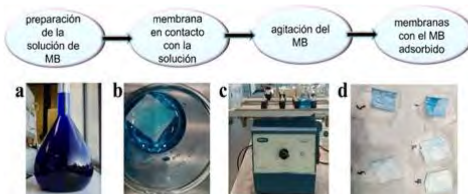
Figura 1. Metodología de análisis de la adsorción de azul de metileno. a) preparación de la solución de MB; b) membrana en contacto con la solución; c) agitación del MB y d) membranas con el MB adsorbido.
