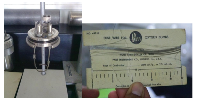
Figura 3. Colocación del alambre y montaje de la muestra en el soporte.
