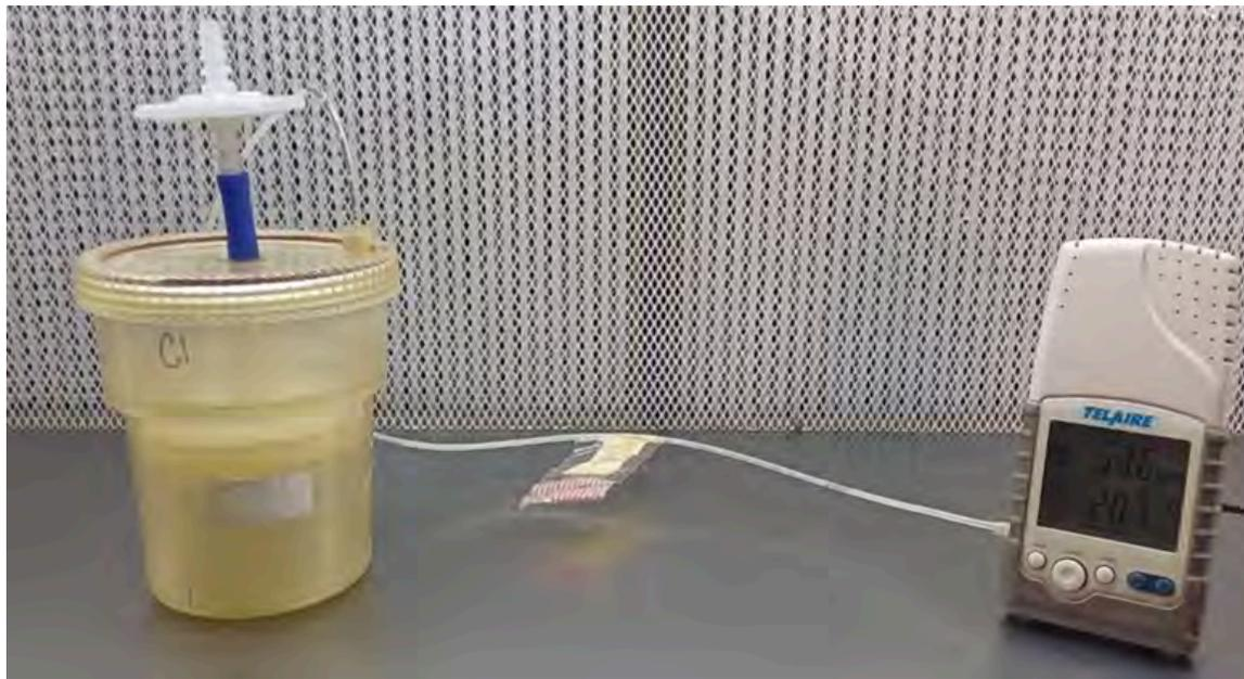
Se esperaron 10 min para estabilizar el medidor antes de registrar las lecturas. Luego, se tomaron mediciones cada minuto durante 2 h para observar el comportamiento del gas en los biorreactores.
