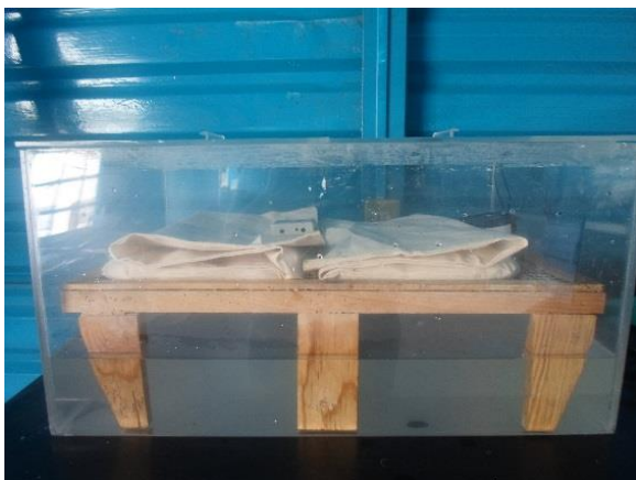
Figura 2. Estructura hermética para generar las atmósferas modificadas y obtener diferentes humedades de equilibrio en el grano de maíz palomero.
