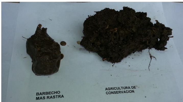
Figura 5. Tamaño de los terrones con B+R y agricultura de conservación, después de un minuto de ser sumergidos en agua.
