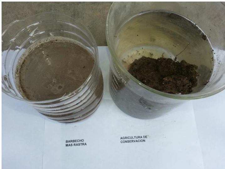
Figura 4. A la izquierda, el terrón de B+R empezó a deshacerse al contacto con el agua, a la derecha, el terrón con agricultura de conservación se conservó casi intacto.
