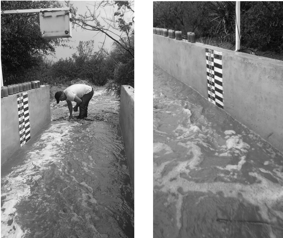
Figura 3. Toma de muestras para determinar la concentración de sólidos en suspensión en un evento de escurrimiento durante agosto de 2016. Cuenca experimental INIFAP, San Luis del Cordero, Durango.
