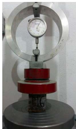
Figura 5. Resistencia a la compresión en la prensa GEOTEST.
