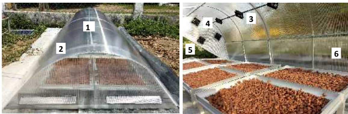
Figura 2. Partes principales del secador solar tipo túnel de policarbonato. 1) cubierta de policarbonato con protección UV; 2) ventanillas que permite la entrada de aire; 3) ventiladores para homogeneizar el calor interior; 4) ventiladores extractores de aire; 5) portacharolas; y 6 charolas.
