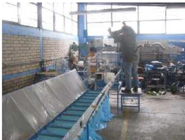
**Figura 2. Banco de prueba del sistema de limpieza y estructura para la colecta de la cáscara.**
