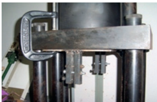
Figura 4. Mecanismo sobre la máquina de tensión.
