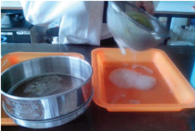
Figura 14. Proceso de separación mediante decantación del líquido por densidad. Al realizar el proceso de separación se realizó igualmente un proceso de filtrado con malla de 500 micras para remover residuos.
