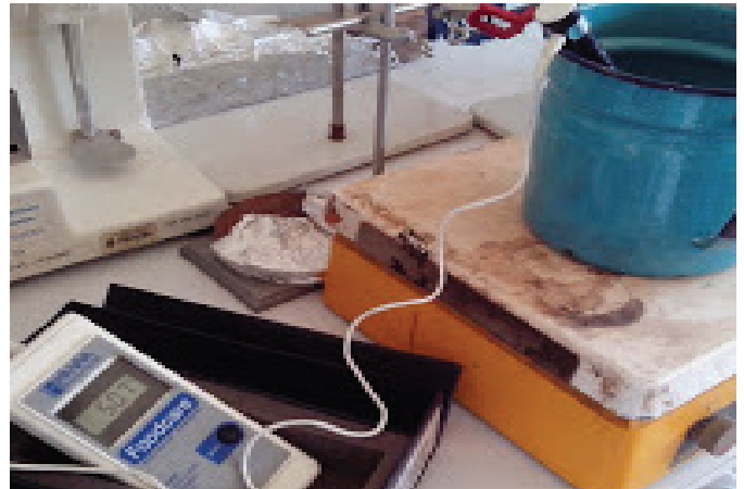
Figura 12. La mezcla de nopal y agua fue sometida a un proceso de calentamiento mediante equipo de laboratorio thermoline a fin de alcanzar una temperatura óptima para el aprovechamiento de los carbohidratos en la mezcla.
