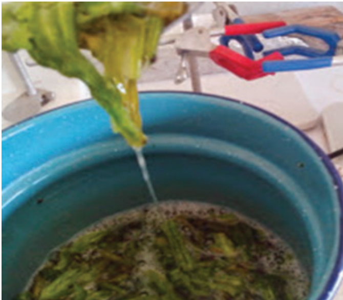
Figura 11. La mezcla de nopal y agua fue sometida a un proceso de calentamiento mediante equipo de laboratorio thermoline a fin de alcanzar una temperatura óptima para el aprovechamiento de los carbohidratos en la mezcla.
